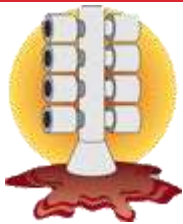
(d) dry ceramic melt out the wax fire ceramic (burn wax)
